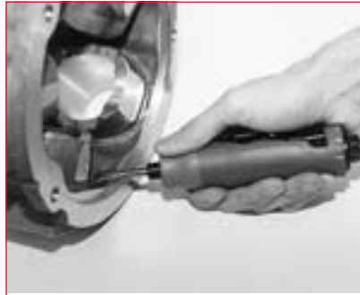
Modell 12S1000-36 bei der Nachbearbeitung eines Gußwerkstückes
