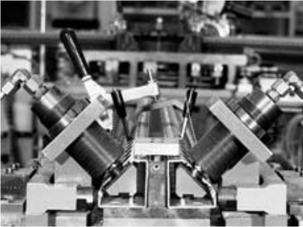
Hydraulik-Einschraubzylinder, einfachwirkend (Katalog-Seiten 23.1 und 23.2) zum Spannen von Profilen an einer Fräsmaschine.
