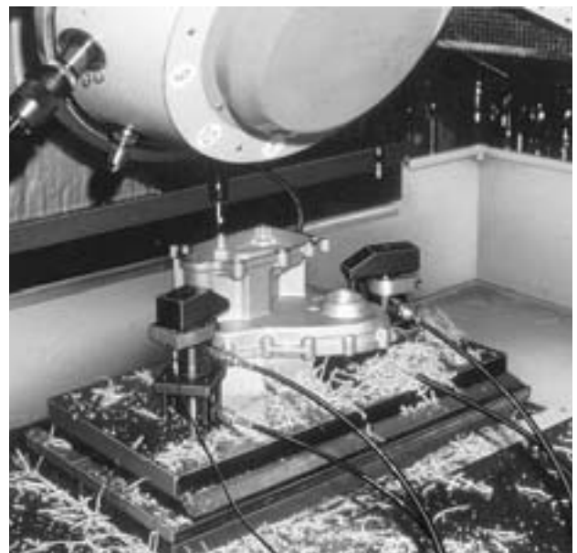
Hydraulik-Schwenkspanner, doppelwirkend (Katalog-Seiten 24.1-24.4) zum Spannen von Gußteilen an einer Fräsvorrichtung.
