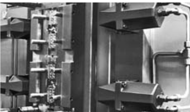
Hydraulik-Spannklaue, doppeltwirkend (Katalog-Seite 24.5) zum Spannen eines Formwerkzeugs an einer Spritzgießmaschine.
