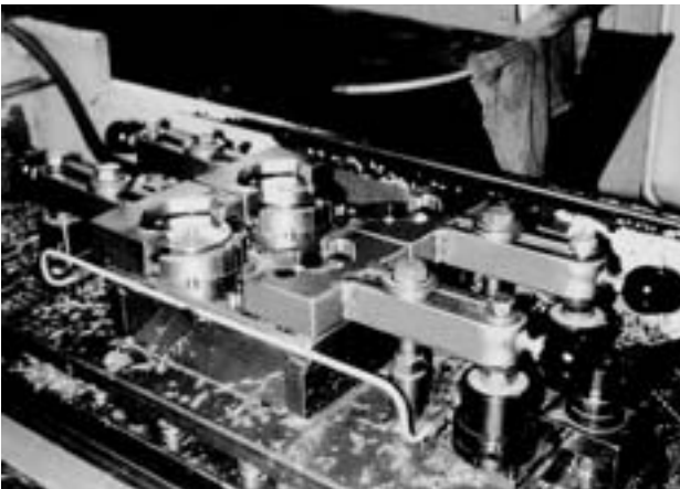
Hydraulik-Hohlkolbenzylinder, einfachwirkend (Katalog-Seite 23.13 bis 23.14) zum Spannen auf einer Fräsvorrichtung.
