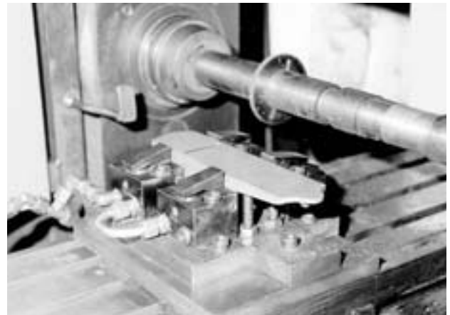
Hydraulik-Niederzugspanner, einfachwirkend (Katalog-Seite 24.7 bis 24.8) zum Spannen auf einer Fräsvorrichtung.
